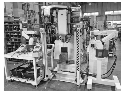
新開発の刻印や打刻機、ロボットなどからなるマーキングシステム
