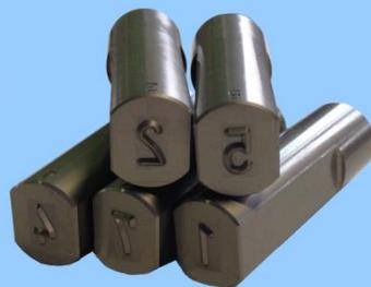
インパクト式刻印機『AK-100』はターレット式のエアーク印機です。12本保持でき、1文字ずつ選択して打刻を行います。ランダム番号の刻印作業に適しています。
